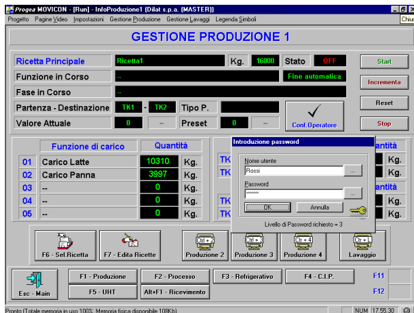
Fig. 4: l'operatore ha la possibilità di lanciare fino a quattro produzioni contemporanee. Il sistema provvede automaticamente ad utilizzare le utenze quando disponibili e pulite. Le operazioni sono sottoposte alla operatori autorizzati eventuali procedure di ripristino fuori ciclo.
