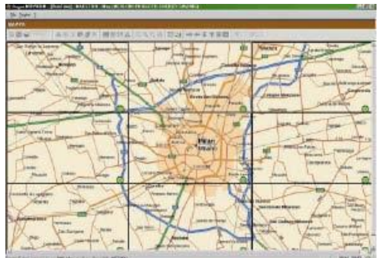
Figura 2 - È qui esemplificata l'interazione tra mappa, anagrafica e telecontrollo. Una luce verde in ogni quadrante, in basso a destra, simbolizza che da quella zona non sono stati generati allarmi.
