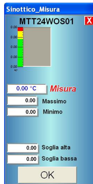
Esempio di finestra pop-up parametrizzata con la personalizzazione dinamica dei set-points.
