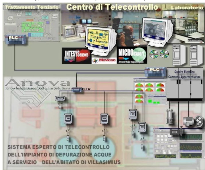
La pagina principale del sistema di telecontrollo del depuratore di Villasilimus, realizzato con lo Scada Movicon di Progea.
